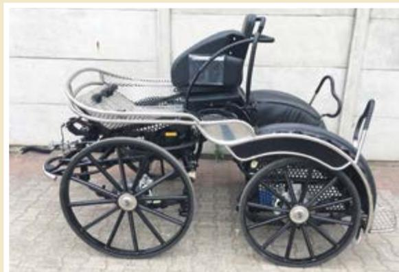
weiterentwickelt: Zweispanner Marathonwagen mit großem Drehkranz und Halbfeder hinten
